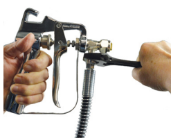
2) Monter le "pistolet de pulvérisation de base" sur le tuyau, en serrant bien l'écrou.
